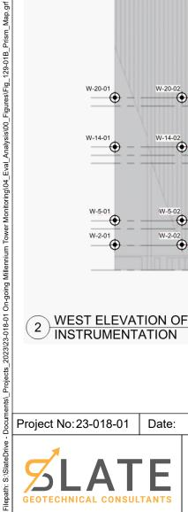
TOWER SURVEY PRISM LOCATION SCHEMATIC
